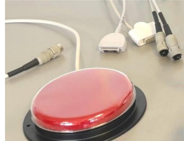
Ce ST-CONTACT-3 fonctionnera sur plusieurs systèmes via ces deux prolongateurs.
